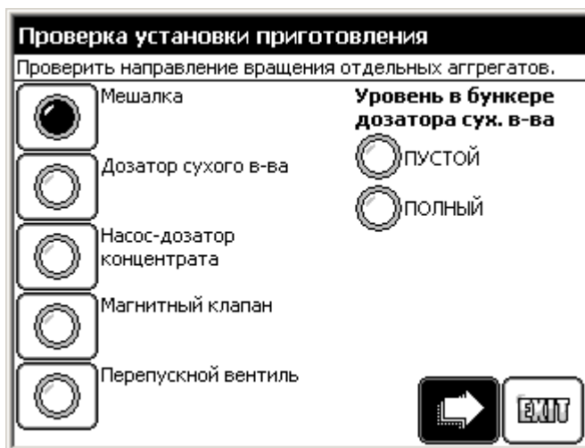
Рис. 57.1 Сервисное меню: заводская проверка агрегата
